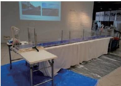
東北工業大学の田中礼治名誉教授による津波に強い建築を学ぶ実験室。ティッシュの空き箱を切り貼りして、津波に強い建物を工夫して製作します。津波実験装置により発生させた模擬の津波に対し、津波に強い建物、弱い建物を比較して建物を強くすることの重要性を学びます。お子様はもちろん、大人も楽しんで学べるワークショップです。
